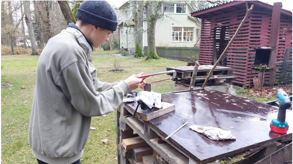
Foto 4. Näpulapi plaadi väljalõikamine plekist. Autor: Margus Soa, 2022.
