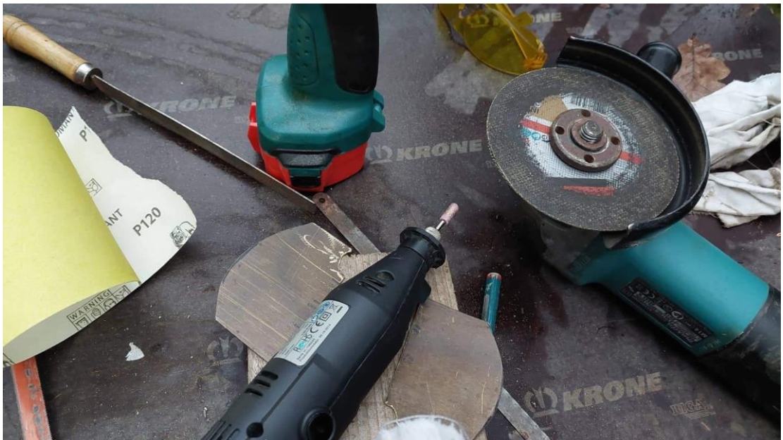
Foto 5. Näpulapi plaadi lihvimine ja jõnksu saavutamine. Autor: Mihkel Soa, 2022.
