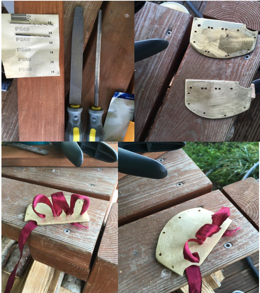
Fotod 8-12. Näpulasi plaatide ülelihvimine ja üle puurimine. Autor: Mihkel Soa, 2022.
